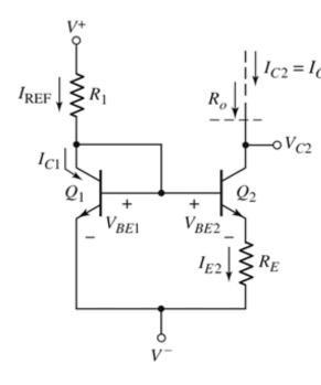
$$i_{C} = I_{S}e^{v_{BE}/V_{T}}; \text{npn}$$
